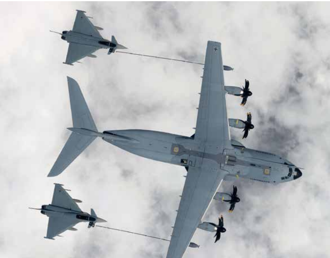
Luftbetankungsmanöver gehören zu den komplexesten des militärischen Flugbetriebs. Bis auf wenige Meter nähern sich die beteiligten Luftfahrzeuge wie hier ein A400M und zwei Eurofighter über Norddeutschland. (Quelle: Bundeswehr/Christian Timmig)
