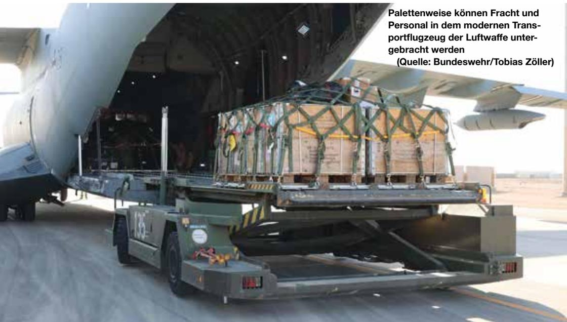
Palettenweise können Fracht und Personal in dem modernen Transportflugzeug der Luftwaffe untergebracht werden
