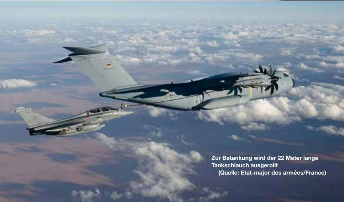
Zur Betankung wird der 22 Meter lange Tankschlauch ausgerollt
